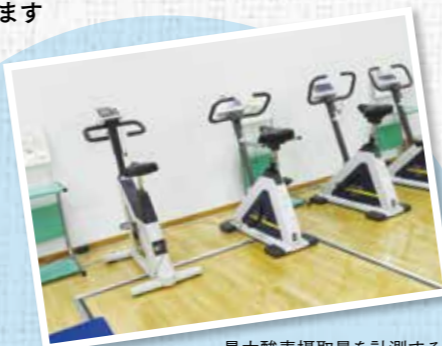
最大酸素摂取量を計測するための自転車漕ぎ装置
